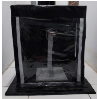
Gambar 2. Alat pendulum sederhana dengan kotak tertutup untuk mengurangi pengaruh hambatan udara.
