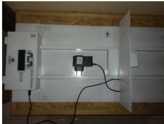
Gambar 3. Alat Praktikum Pengukur Cepat Rambat Bunyi dengan Menggunakan Sensor Ultrasonik
