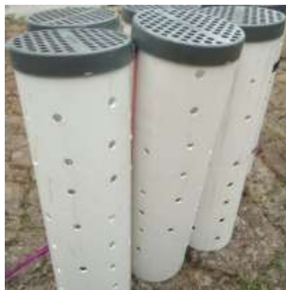
Gambar 1. Pipa Paralon Untuk Lubang Resapan Biopori
